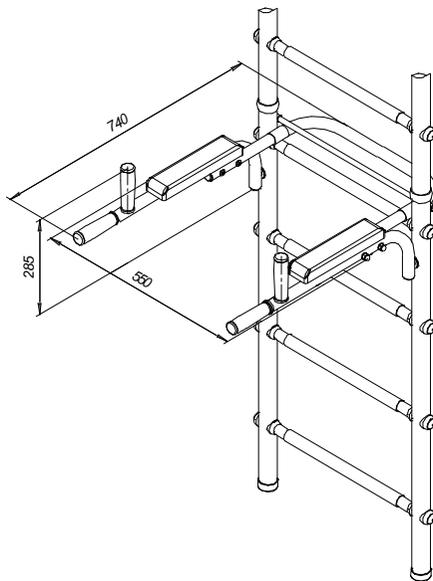
**Рис.2 Установка брусьев.**
